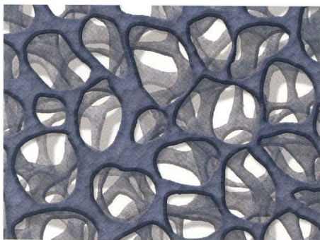
V.A.C.® GranuFoam tillverkas av öppet, nätliknande polyuretanskum (PU).
